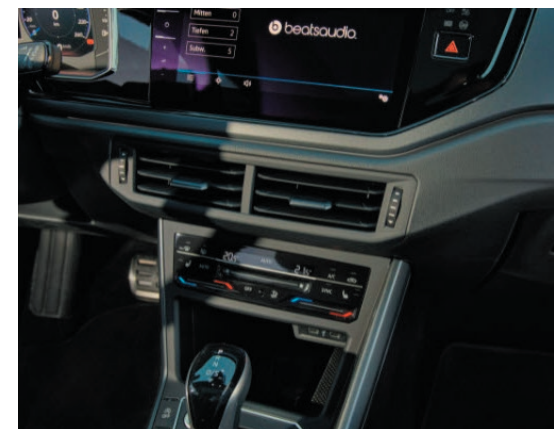
2-Zonen Klimaanlage „Air Care Climatronic“.
